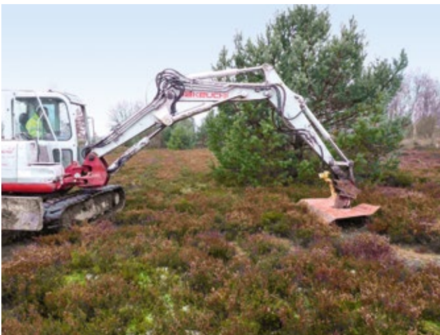
Abb. 110 & 111: Kleinbagger mit Böschungsschere und Auffangblech bei der Heideernte (l.) und Heidekrautpflanzen zwischen einer fast geschlossenen Moos- und Flechtenschicht im dritten Jahr nach Maßnahmenumsetzung (r.) (Fotos C. Dolnik).
