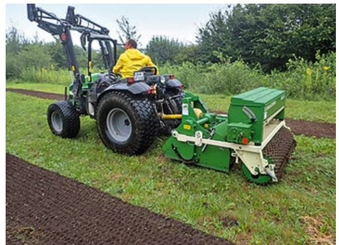
Abb. 11: Eine Umkehrfräse in Kombination mit Einsaatgerät und nachlaufender Gitterwalze für Kommunaltraktor kann kleinflächig zur furchenlosen Streifeneinsaat (im Vordergrund) und Artenanreicherung in verarmten Dauergrünlandflächen oder zur Anlage von Insekten-Saumstreifen auch im Siedlungsbereich eingesetzt werden (Foto C. Dolnik).
