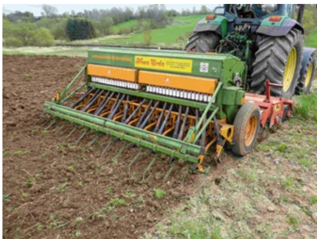
Abb. 33 & 34: Amazone-Einsaatkombination mit vorlaufender Fräse und nachlaufendem Striegel und Dutzi-Einsaatkombination mit vorlaufendem Rotorzinken und nachlaufender Walze, bei der die Saatkörner bodennah ausgestreut werden und die auch ohne Schrot gute Ansaatergebnisse erzielen (Fotos C. Dolnik).
