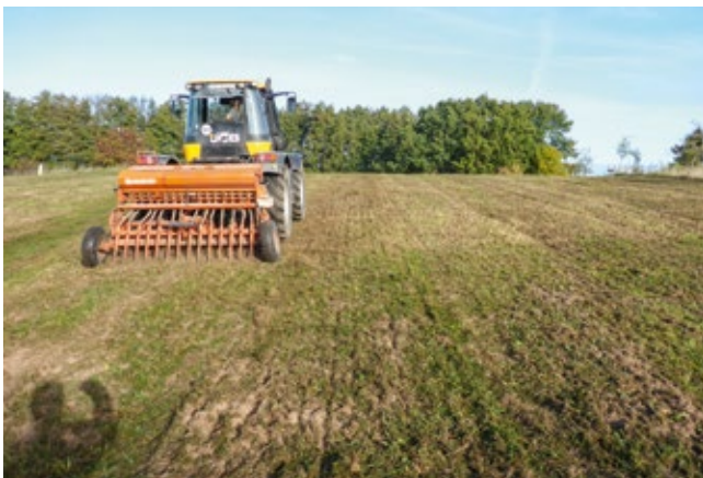
Abb. 19: Einbringung einer mit Klappertopfsaat angereicherten Regio-Saatmischung mit einer Rillenfräse-Saatkombination im Oktober. Unmittelbar zuvor wurde die Fläche mit einem Schlegelmulcher gemulcht (Foto B. Rickert).
