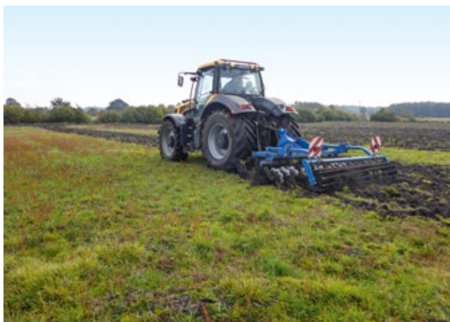
Abb. 12 & 13: Die Bearbeitung mit der Scheibenegge entspricht der Wirkung eines flach arbeitenden Pfluges. Durch mehrmaligen Einsatz (2–3 Durchgänge) in unterschiedlichen Fahrtrichtungen wird vorhandene Vegetation effektiv zerkleinert und eingearbeitet. Im Bild die Bodenbearbeitung auf einer einjährigen Ackerbrache und das Ergebnis nach drei Arbeitsdurchgängen. Bereits vorhandene unerwünschte Arten wie Quecke und Acker-Kratzdistel werden nicht nachhaltig bekämpft und regenerieren schnell (Fotos B. Rickert).
