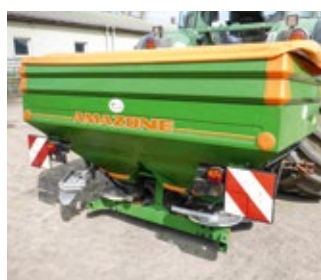
Abb. 35 & 36: Düngerstreuer und Salzstreuer für die Aussaat, für die zusätzlich Schrot als Wurfkorn für eine gleichmäßige Verteilung der unterschiedlich großen Samen eingesetzt werden sollte (Fotos C. Dolnik).
