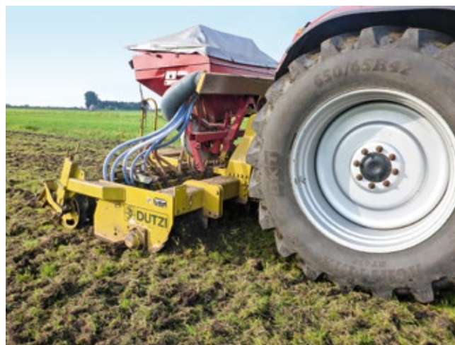
Abb. 33 & 34: Amazone-Einsaatkombination mit vorlaufender Fräse und nachlaufendem Striegel und Dutzi-Einsaatkombination mit vorlaufendem Rotorzinken und nachlaufender Walze, bei der die Saatkörner bodennah ausgestreut werden und die auch ohne Schrot gute Ansaatergebnisse erzielen (Fotos C. Dolnik).
