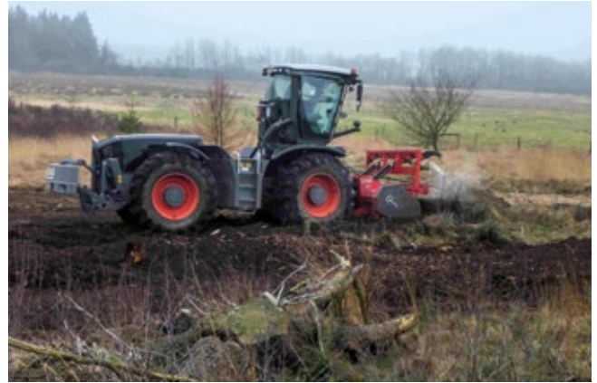
Abb. 81 & 82: Windwurfflächen eines Nadelforsts (links) auf einer Binnendüne werden mit dem Forstmulcher (rechts) aufgearbeitet (Fotos C. Dolnik/B. Rickert).
