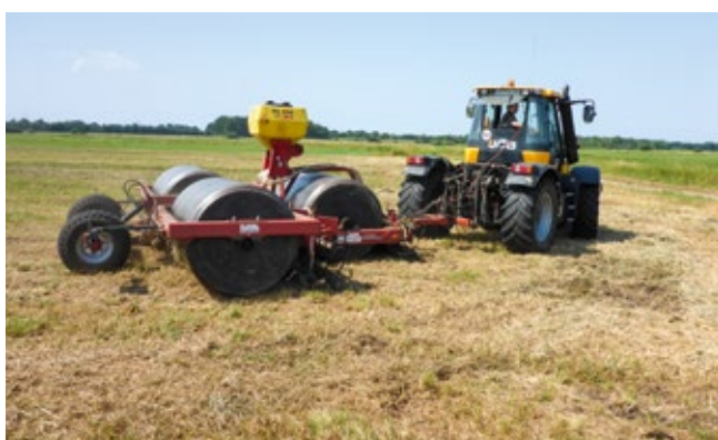
Abb. 27: Striegel-Saatkombination mit pneumatischer Saatausbringung und nachlaufenden Glattwalzen (Foto B. Rickert 27.7.2018).
