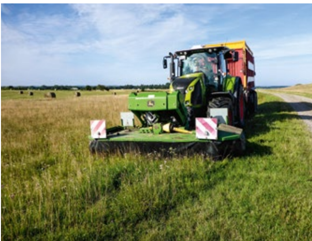
Abb. 39 & 40: Morgens wird die artenreiche Wiese auf dem Truppenübungsplatz Putlos (Spenderfläche) mit einem Frontmäherwerk und nachgeführtem Ladewagen mit Pickup und Kratzboden geerntet und sogleich auf die mit einer Untersaat vorbereiteten ehemaligen Maisackerfläche in der Preetzer Postseefeldmark mit dem Ladewagen ausgebracht (Fotos C. Dolnik).
